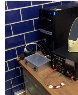
Figura 5. Receptor de radio Jove de la NASA en el plantel 7 "Ezequiel A. Chávez" que opera con una frecuencia de 20.1 MHz
